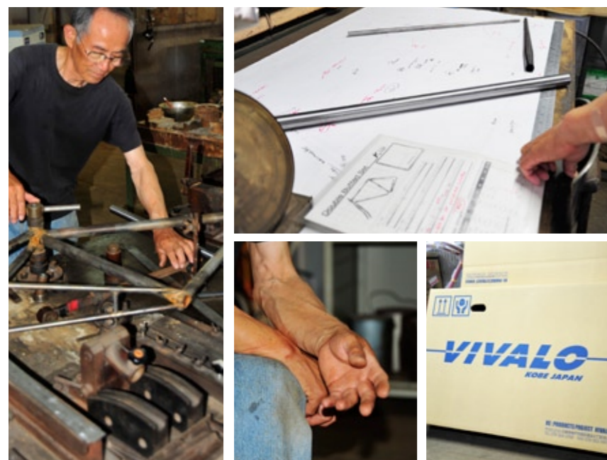
▲フレームを固定しているのは自ら考案した機械。
